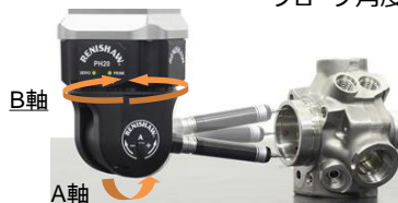
※ヘッドタッチ・・・ヘッドの回転のみで測定動作
